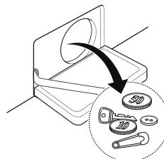
**4** Po vyčistení zatvorte filter čerpadla a vložte zátku odtokovej hadičky čerpadla.
