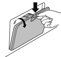
**2** Vytiahnite zátku odtokovej hadičky čerpadla a otvorte filter otočením doľava.
