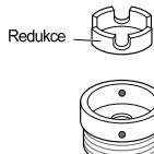
**3** Nasadte adaptér na konec kohoutu, aby pryžové těsnění vytvořilo vodotěsnou přípojku. Utáhněte čtyři upevňovací šrouby.
